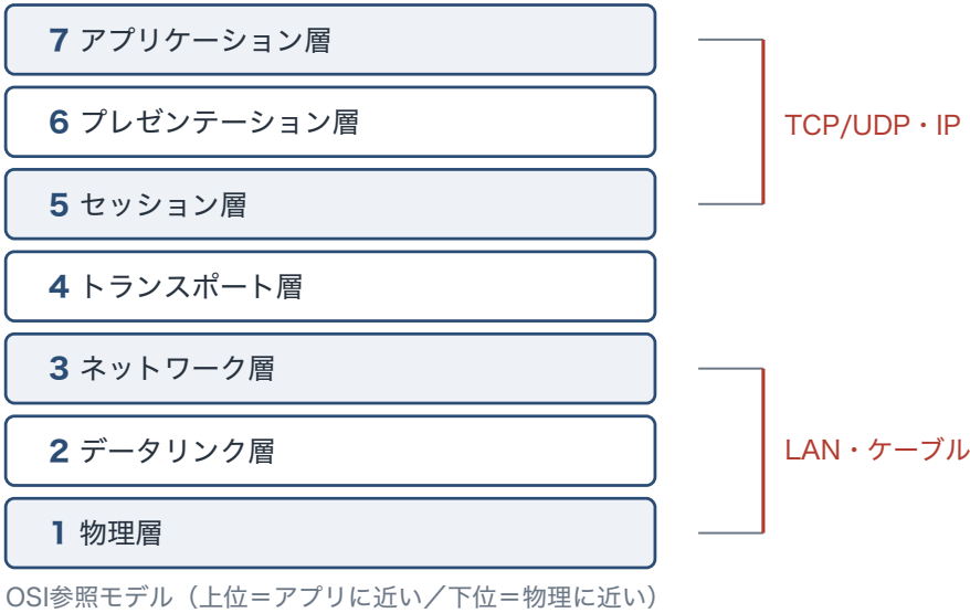
図 2-2 OSI参照モデル7階層とTCP/IPの対応
